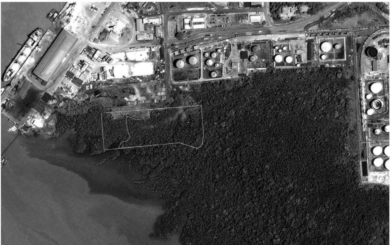
Figura nº 3 - No ano de 2009 já se nota ao norte do armazém o avanço do aterro sobre o manguezal. Observam-se, à direita e acima da linha em verde e amarelo que delimita o armazém, sinais evidentes de degradação do manguezal.
